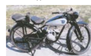
Technische Daten: 98 qcm, 3 PS, 2-Gang, 69 kg, 55-60 km/h, 1,9 L/100km, Bereifung 26x25,0, produziert 1936-1953.
