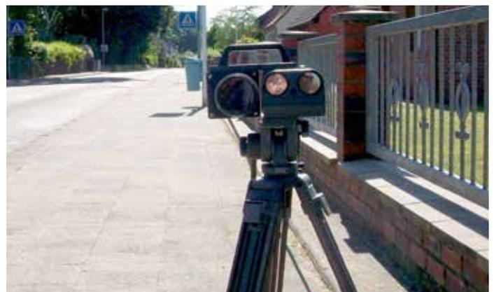
*Mobiles Messgerät zur Geschwindigkeitsüberprüfung.*
